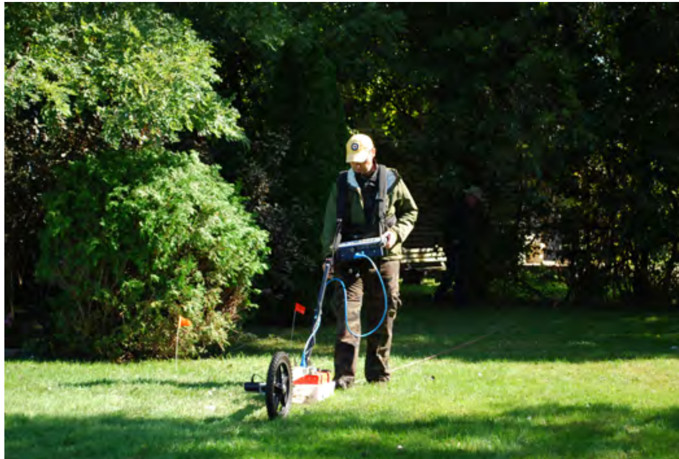
Utilisation d'un géoradar au cimetière familial Henson en 2011.
