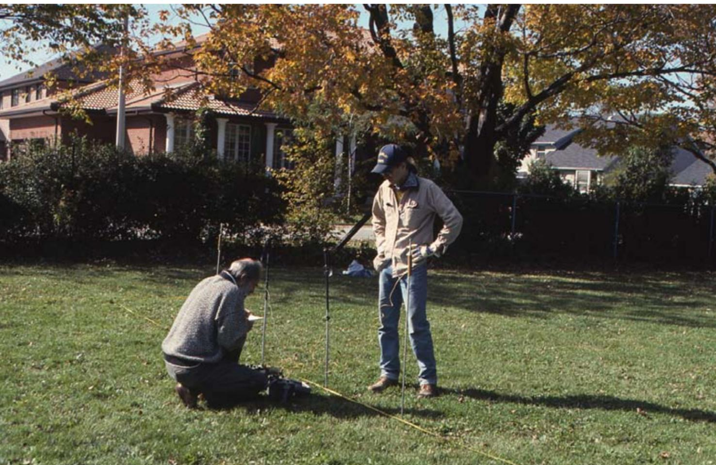
Plusieurs méthodes géophysiques ont été employées dans la propriété Chedoke de la Fiducie, à Hamilton, y compris la tomographie de résistivité électrique (voir la photo), le magnétomètre et le sondage électromagnétique.
