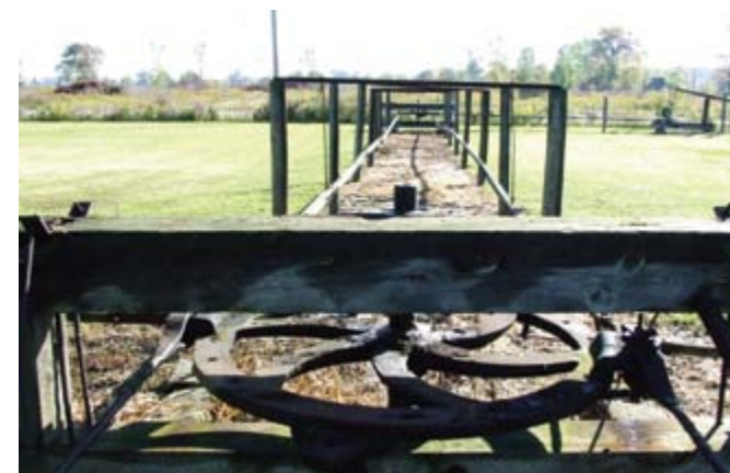
Les roues (que l'on peut voir sur cette photo) et le système de pompes à tiges à saccades sont encore utilisés par Fairbank Oil Properties aujourd'hui, sensiblement de la même manière que dans les années 1860. Photo : Oil Museum of Canada (musée canadien du pétrole).
